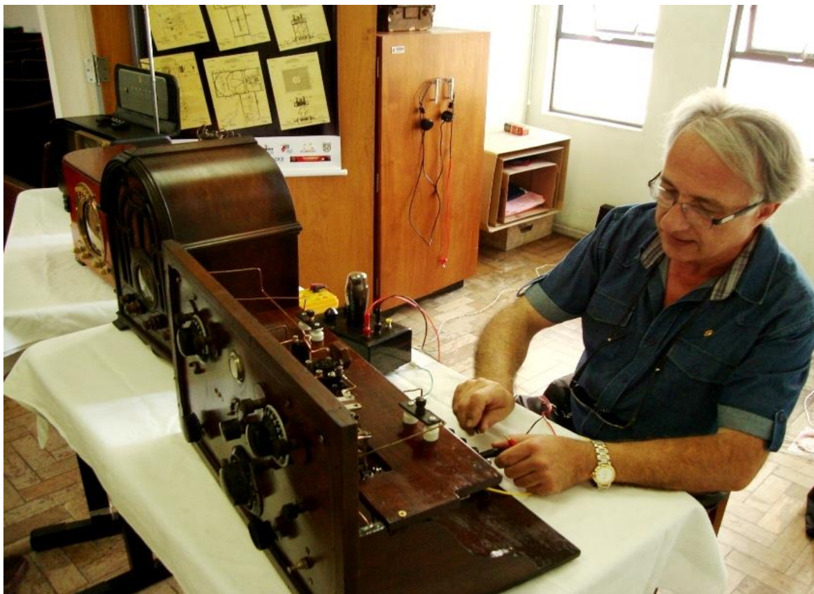
Um dos mais antigos receptores comerciais. Em meados da década de 1920, eram vendidos “kits” para montagem de receptores primitivos. Este regenerativo utiliza duas válvulas UV200, de 1924.
